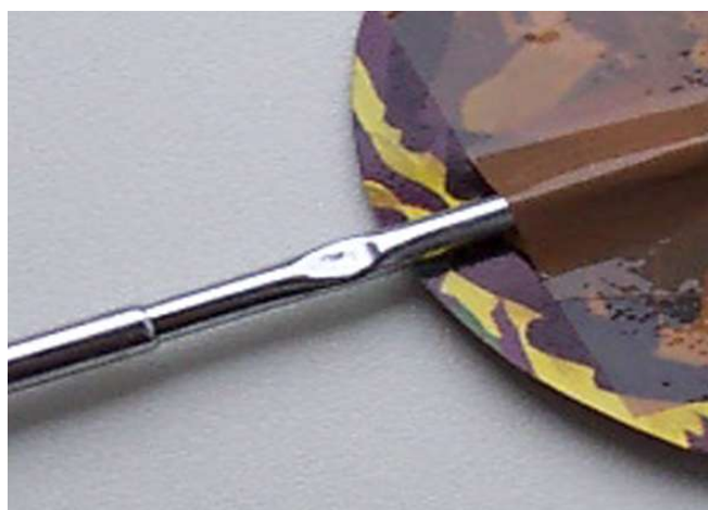
Detail snímku, kde je vidět zoubek přímo pod kolečkem, to aby se anténa nezasunula až do konce a nestrhla kolečko.
