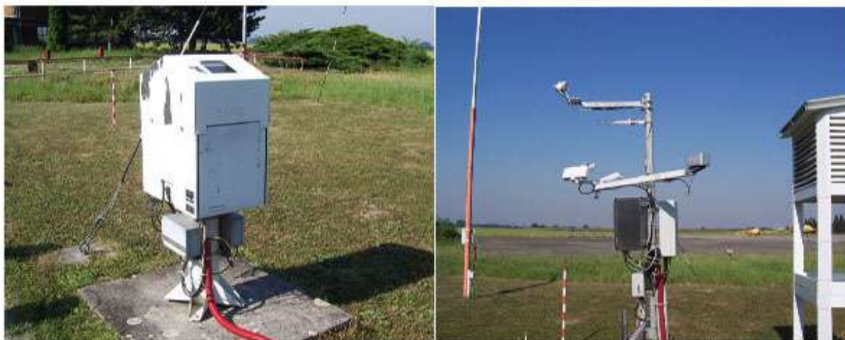
Obr.4.: Pohled do budky na teploměry, Řada srážkoměrů, Zařízení na měření výšky základny oblačnosti, Různé digitální přístroje a srážkoměr (odesílá záznamy do počítače).
